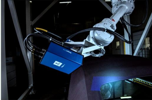
Streifenlichtscanner mit einem Messvolumen von  $100 \times 100 \times 120 \text{ mm}^3$  bei einer Entfernung von 220 mm bis 320 mm.
