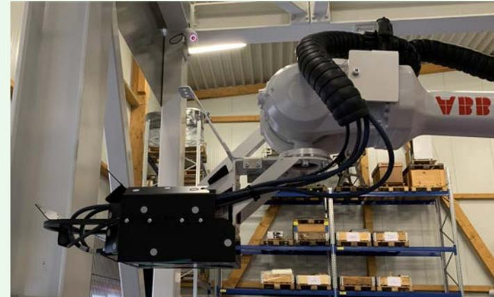
Streifenlichtscanner mit retroreflektierenden Messmarken (Roboterlokator) für das übergeordnete Kamerasystem.
