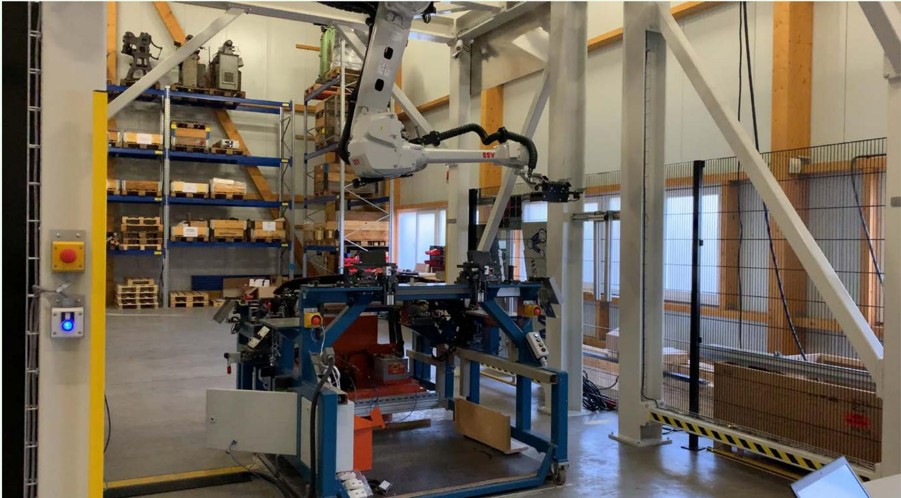
Mit Hilfe des optischen Systems konnte die absolute Positionsgenauigkeit des Roboters von 5mm auf eine Standardabweichung von 40  $\mu\text{m}$  gesenkt werden. Festgestellte Abweichungen können direkt in die Produktion zurückfließen, um dort den Produktionsprozess unmittelbar zu verbessern. © ISW
